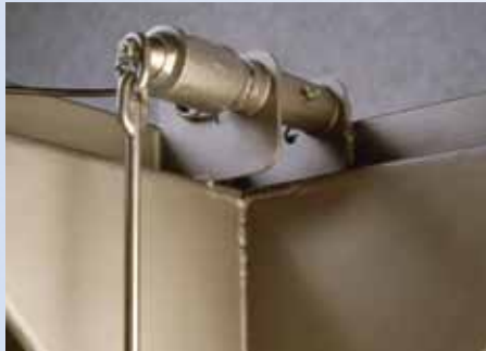
Celdas de carga ubicadas fuera de áreas de peligro.
